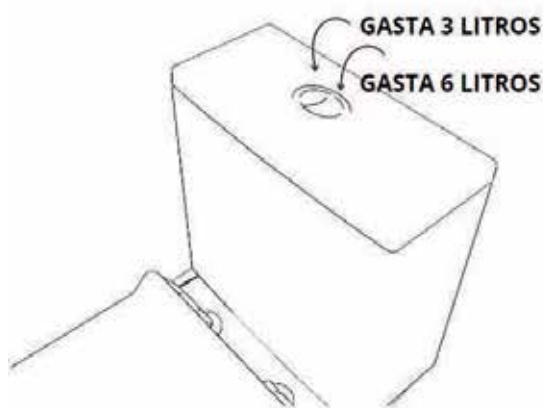
Figura 56. Representação de bacia sanitária de comando duplo.
