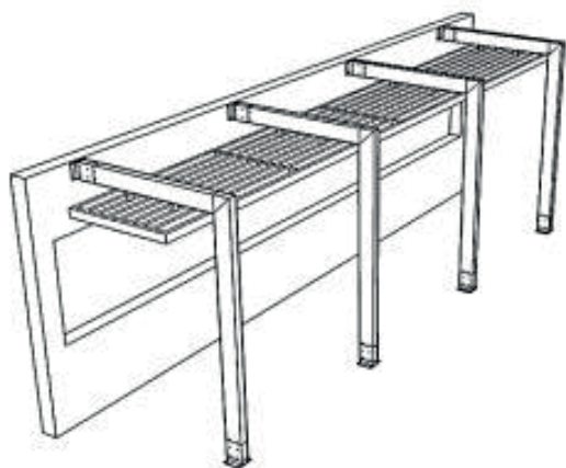
Figura 31. Sombreador externo horizontal com aletas.
